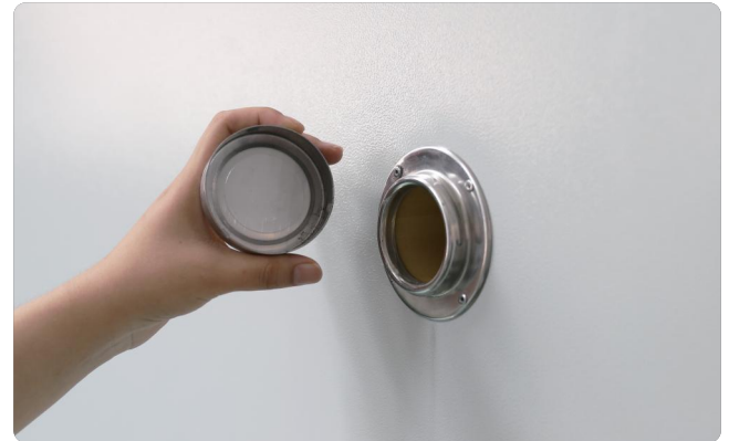
2-inch cable port
